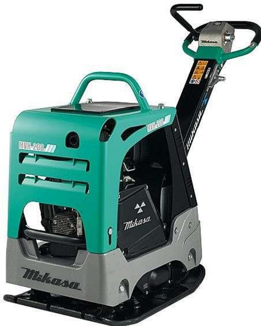
Реверсивная вибрационная плита Mikasa MVH-208GH - модель с бензиновым двигателем Honda, обладающая силой удара в 37 кН и частотой 3600 ударов в минуту. Благодаря тому, что машина может двигаться как вперед, так и назад, она идеально подходит для работы в условиях, где невозможно развернуться (например, в траншеях или при проведении фундаментных работ).
